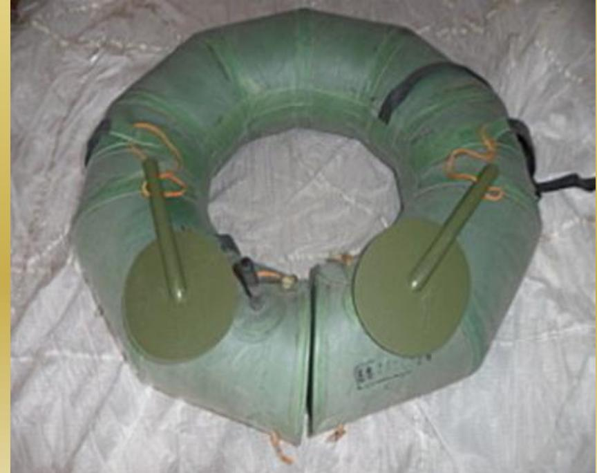
**Местные плавающие средства** (лодки, катера, паромы, бочки, автомобильные камеры, различные поплавки), а также **местные материалы** (бревна, брусья, доски, хворост, тростник, камыш, солома) применяют для устройства десантных и паромных переправ при отсутствии или недостатке переправочных средств инженерных войск. Из местных плавающих средств и материалов готовят паромы, плоты, плотинки, поплавки.
