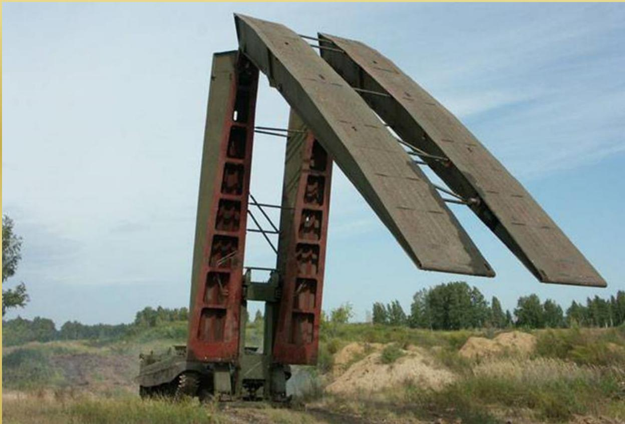
Трехсекционный мост комплекса МТУ-90М позволяет преодолевать различные препятствия шириной до 19 метров. Конструкция допускает проезд техники весом до 60 тонн против 50 тонн у МТУ-90. По мосту могут передвигаться не только гусеничные или колесные боевые машины, но и автомобильная техника различных классов. Он может полноценно участвовать в спасательных операциях.
