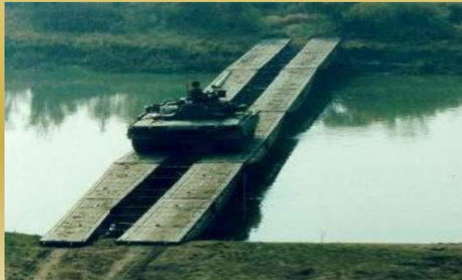
Тяжелый механизированный мост ТММ-3 предназначен для устройства мостовых переходов через препятствия **шириной до 40 м и глубиной до 3 м** с целью пропуска через них колесных и гусеничных нагрузок весом **до 60 т**. Комплект моста состоит из четырех мостоукладчиков на шасси автомобиля КрАЗ-255Б, несущих на себе мостовые блоки с опорами.
