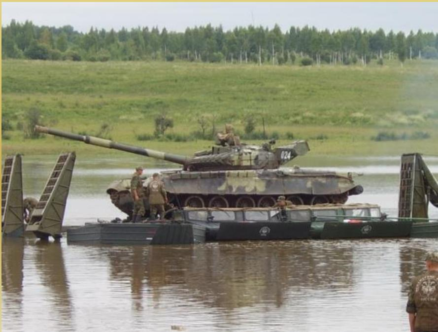
Для переправы через водные преграды танков, самоходных орудий и другой гусеничной техники весом **до 52 тонн** имеются гусеничные самоходные паромы ГСП. Эти машины на марше следуют в танковой колонне и решают задачу переправы тяжелой техники. Скорость на плаву 10км/ час. **Танк, находящийся на пароме, может вести огонь.** Расчет парома ГСП составлял 10 человек, грузоподъемность ГСП – 52 тонны при запасе плавучести 70%, время на развертывание парома ГСП 6-10 минут.
